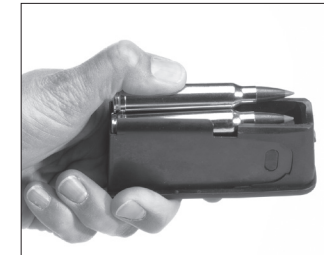
Нажмите на патрон прямо вниз до его защелкивания на месте под подающими загибами.
