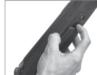
Presione hacia atrás el liberador del cargador. El cargador caerá en su mano.
